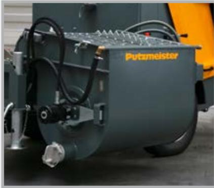
Der große Mischer mit 240 l Volumen und integriertem Wasserdosierrohr macht das Mischen größerer Materialmengen auf der Baustelle möglich, wie zum Beispiel EPS-Gebinde in 200 l Säcken.
