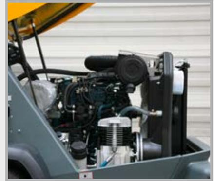
Der leistungsstarke Dieselmotor mit 28 kW mit Dieselpartikelfilter erfüllt die Abgasstufe „Stage V“. Die benötigte Luft bei Spritzanwendungen liefert der eingebaute Kompressor.
