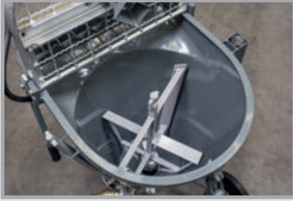
Mischen, Pumpen und Spritzen aus einem Materialtrichter
